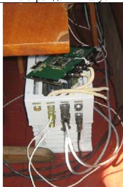
Судовой блок приемовычислительный со специально вынутой платой
