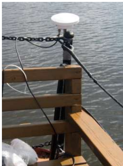
Кормовая приемная антенна ГЛОНАСС/GPS на ограждении палубы
