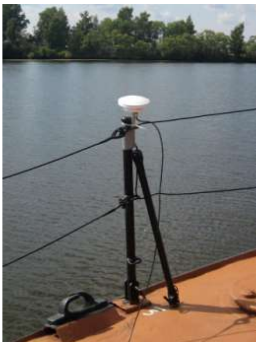
Носовая приемная антенна ГЛОНАСС/GPS на ограждении палубы
