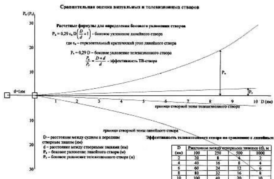
Рисунок 1. Сравнительная оценка точностных характеристик визуальных и ТВ створов.
